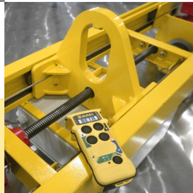
Œillet central réglable pour équilibrer la charge
