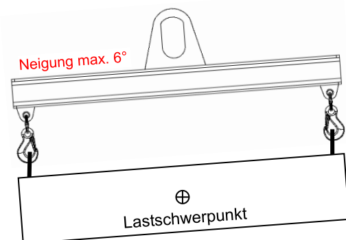
Abbildung 13: Zul. Neigung des Lastanschlagmittels
